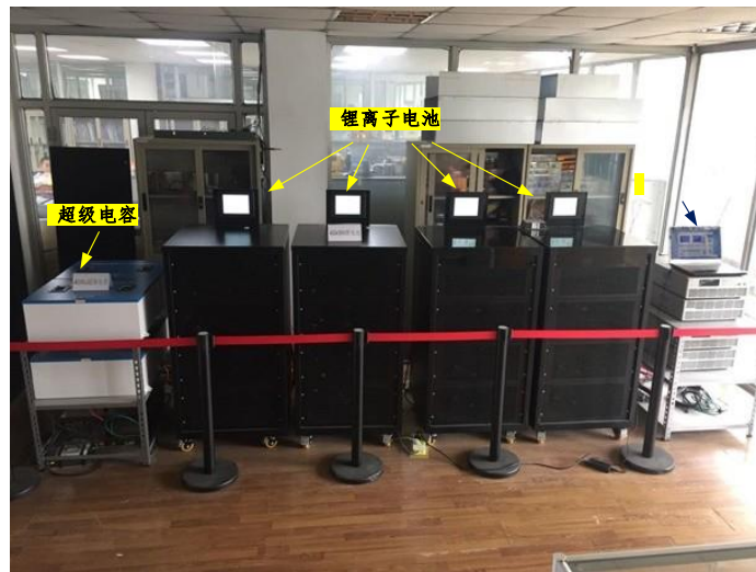
图 1-3 40 kWh 锂电池、400 kJ 超级电容
