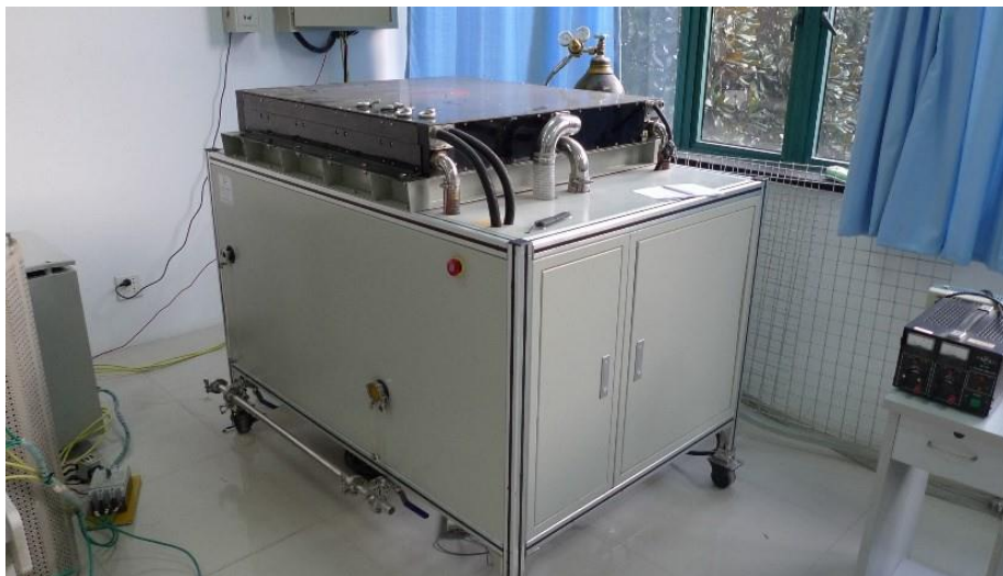
图 1-7 30 kW 燃料电池
